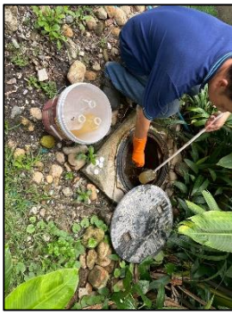
น้ำเสียก่อนเข้าระบบบำบัดน้ำเสีย ชุดที่ 1 การเก็บตัวอย่างเมื่อวันที่ 4 พฤศจิกายน 2568
