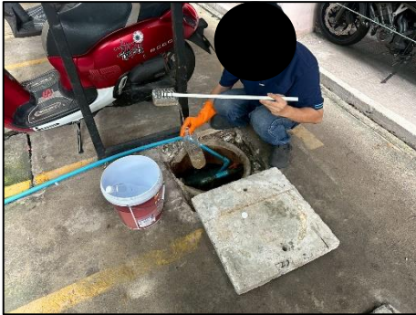
น้ำเสียก่อนเข้าระบบบำบัดน้ำเสีย ชุดที่ 3 การเก็บตัวอย่างเมื่อวันที่ 4 พฤศจิกายน 2568
